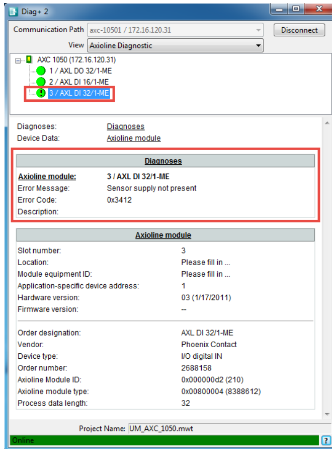
Figure 7-7 AXL DI 32/1-ME Axioline F module: Supply voltage failure
