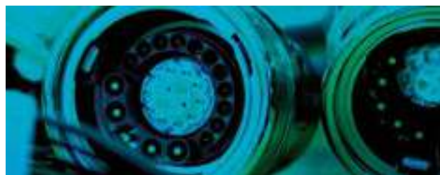
Nur Grün- und Blauanteile im Licht vorhanden (Farbtreuindex < 60) Only the green and blue components are present in the light (colour rendering index < 60)
